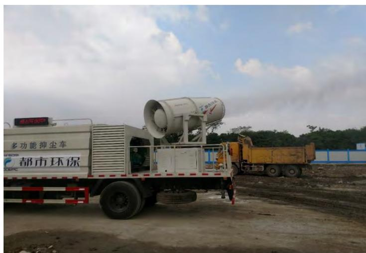
图 7-5 场地平整环节多功能抑尘车降尘示意图
