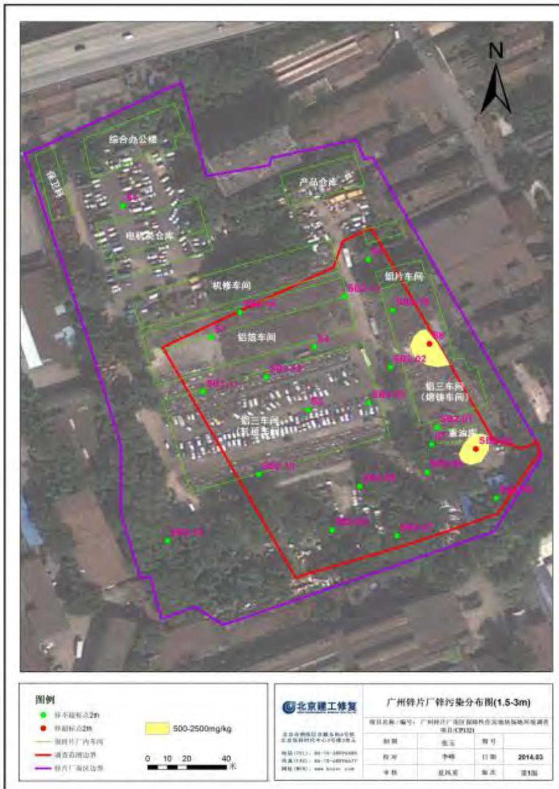
图 3-9 场区锌污染分布图第 2 层（1.5-3m）
