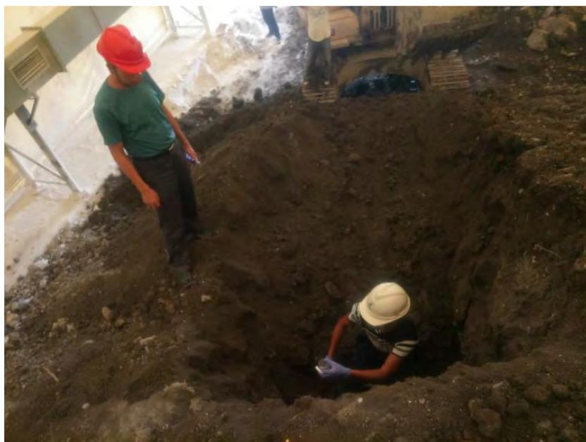
图 8-4 修复后土壤样品采集参照图
