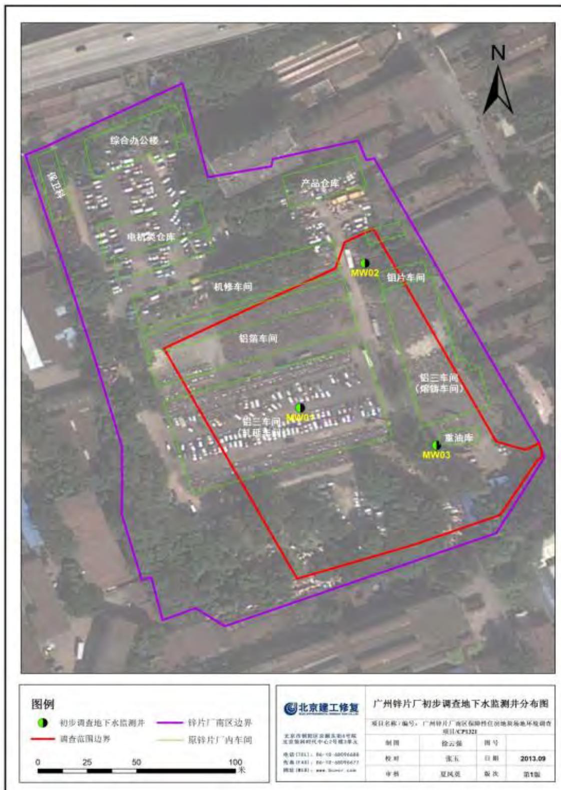
图 3-2 初步调查地下水监测井分布图
