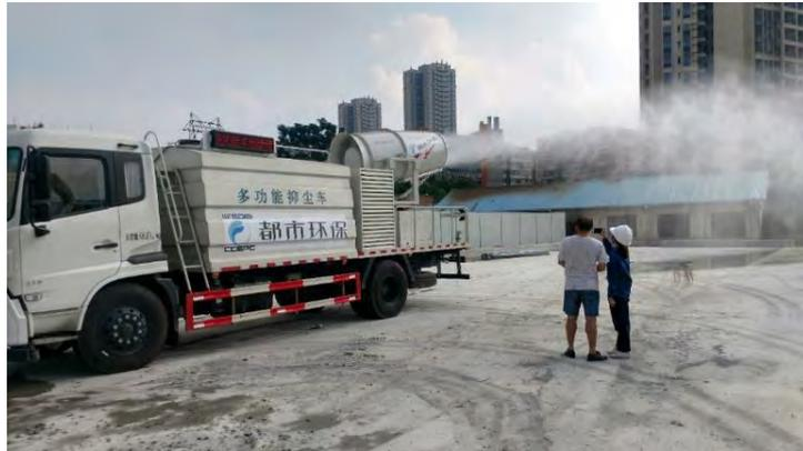
图 7-10 多功能抑尘车喷雾降尘示意图
