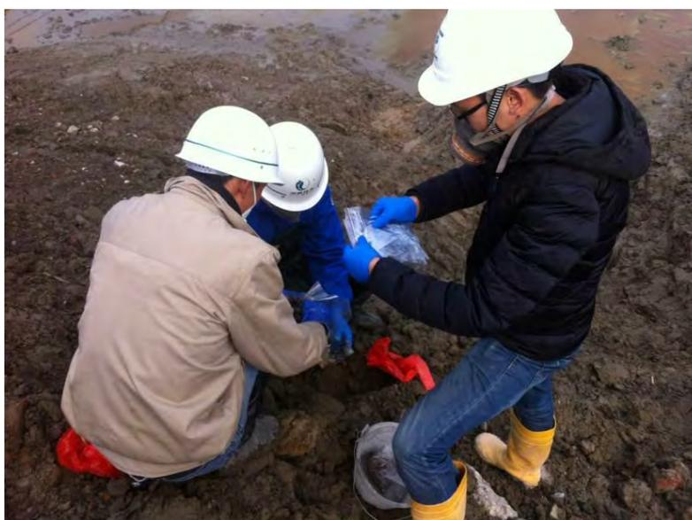
图 7-2 清挖效果验收检测示意图
