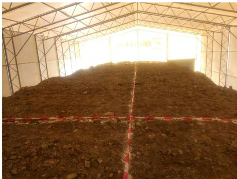
**图 8-3 修复后土壤堆体采样网格划分参照图**
