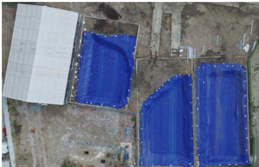
图 7-12 基坑防雨布全遮盖示意图
