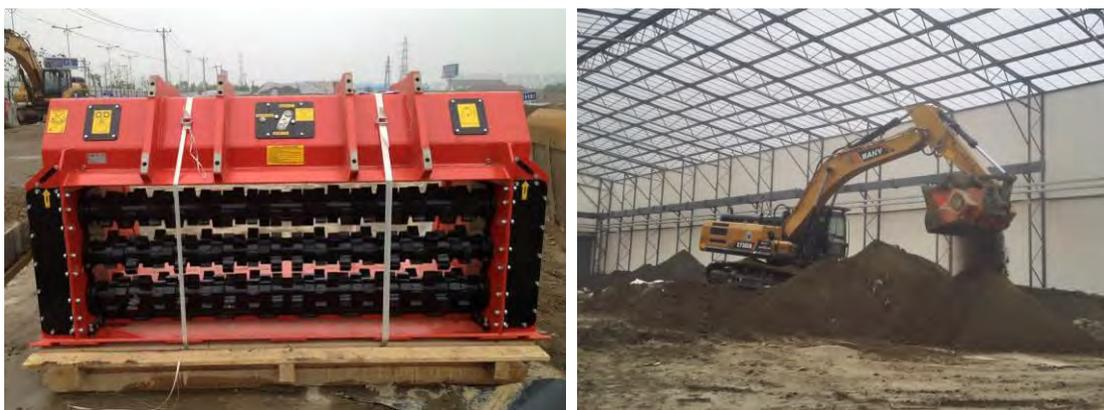
图 6-11 筛分破碎斗实物照片
