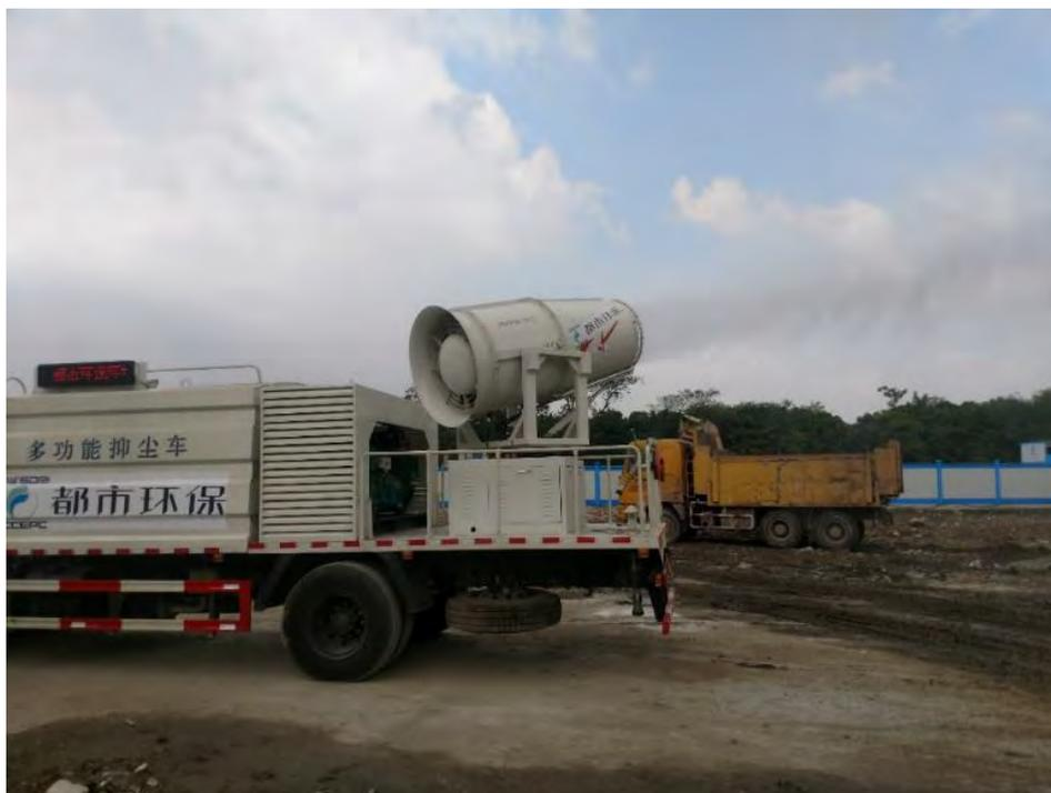
图 10-10 雾炮车洒水降尘示意图
