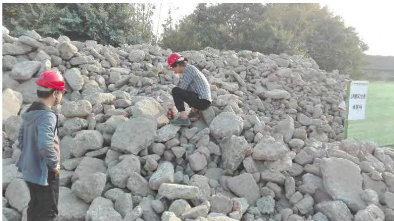
图 8-5 冲洗后的建筑垃圾采样示意图
