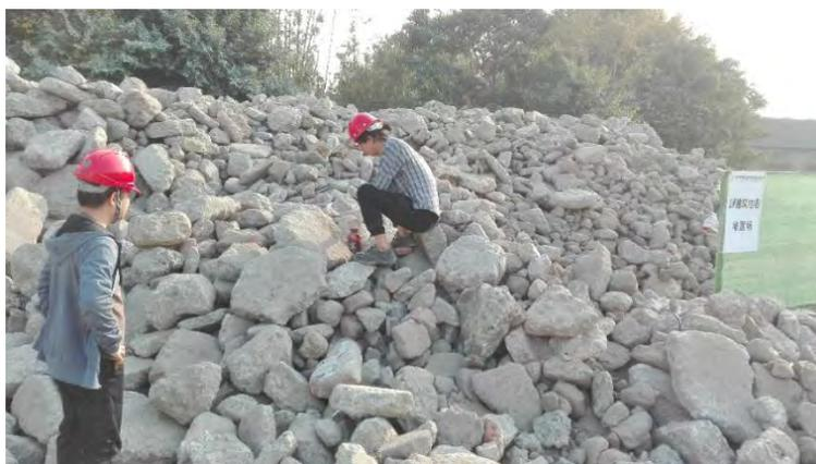
图 6-24 冲洗后的建筑垃圾示意图
